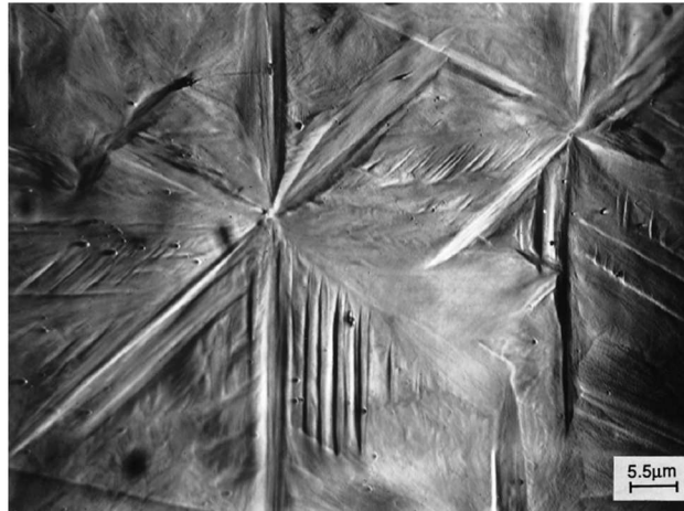
Fig.11.53- Micrografia mostrando o relevo da superfície associada com a bainita superior formada a 450°C em aço com 1,48%W de C. Ref. 11.44.
