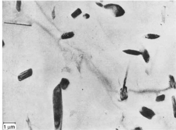
Fig.7.21- Liga Al-4%W de Cu envelhecida para a formação dos precipitados \theta . Ref. 7.1.
